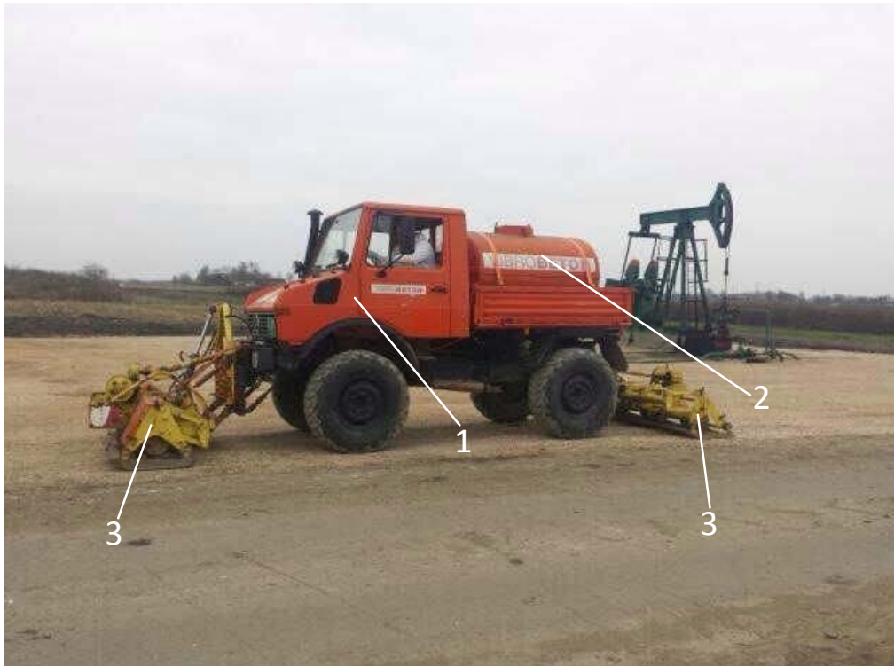
图1 带水箱车载平板振动夯 1—主动力系统；2—供水系统；3—平板振动夯
