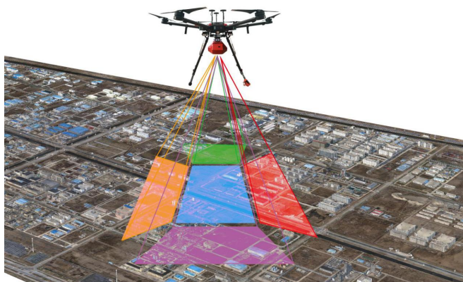
图1 无人机倾斜摄影测量技术在地籍调查外业数据采集中的应用示意图
