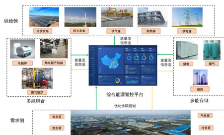
图1 典型综合能源系统结构图
