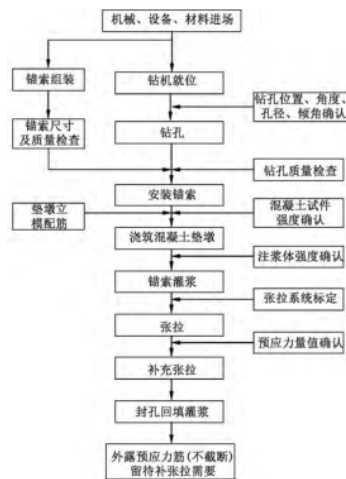
图1 锚索施工流程
