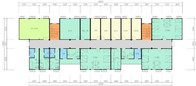
图4 场站综合楼二层平面图
