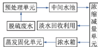
图1 脱硫废水零排放技术路线
