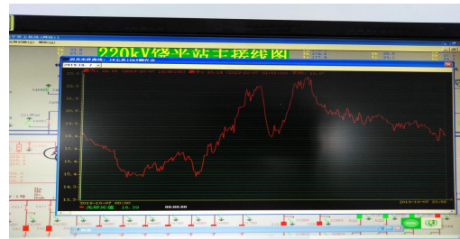
当地监控1号主变低501有功曲线
