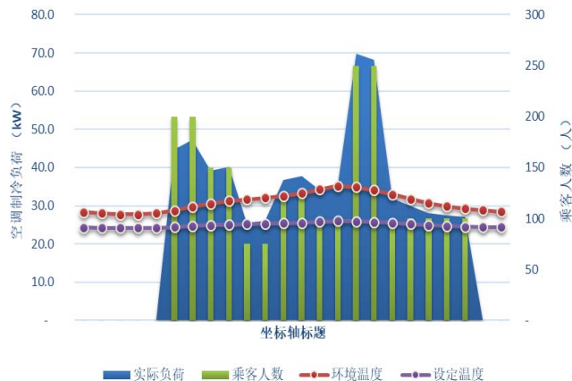
图2 空调夏季制冷日负荷情况（单台空调制冷量37KW）
