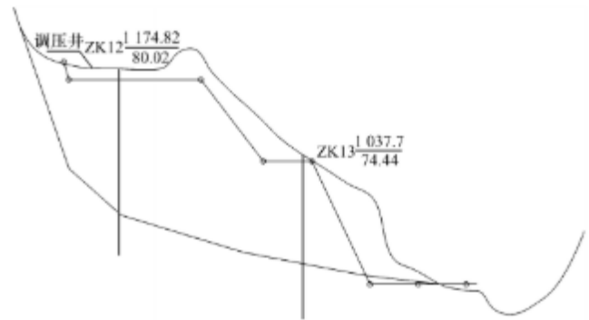
图3 边坡开挖前后稳定性计算剖面示意图 (高程单位: m; 长度单位: m)
