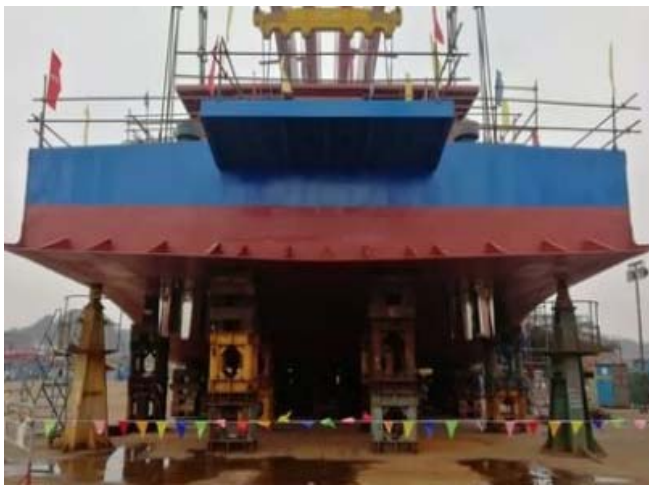
图1 船体结构装配焊接图
