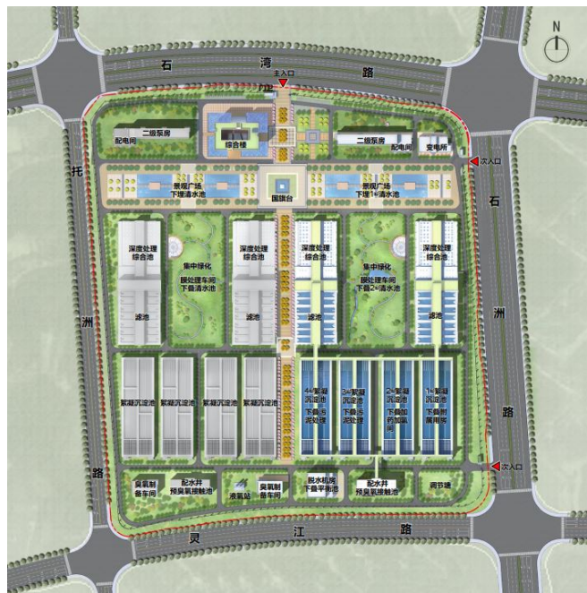
图2 石埭水厂总体设计图
