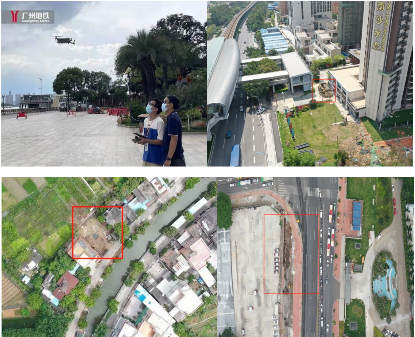
图5 封闭区巡检，红线为识别的保护区施工机具
