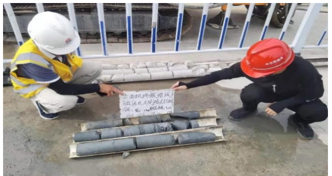
离桩中心 1.2m 取芯芯样 3m (预留桩底 2m 不取穿)
