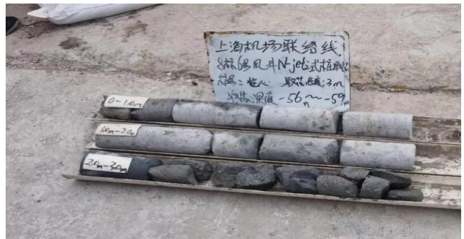
中心取芯芯样 3m (预留桩底 2m 不取穿)
