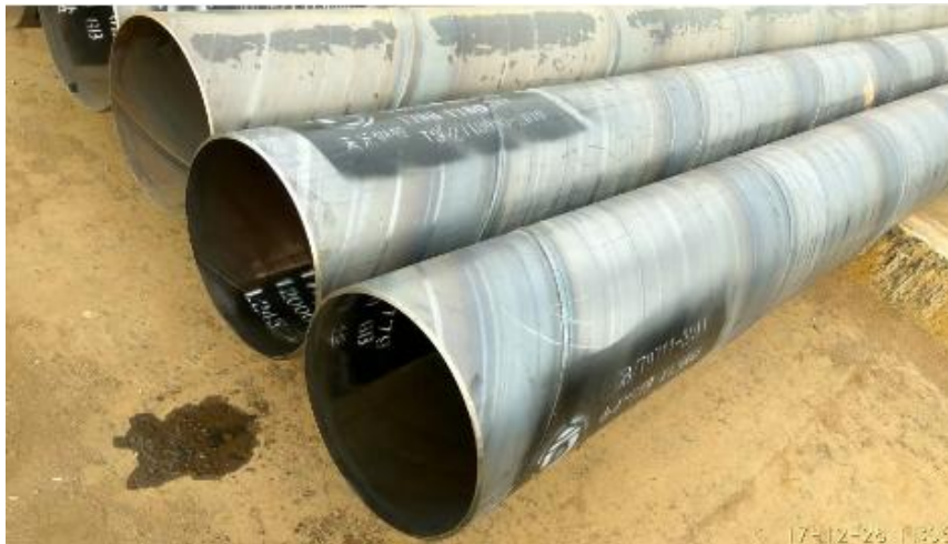
图 1 环氧树脂喷涂处理后的供水管道
