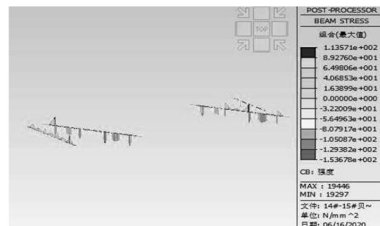
图6 SZX14-15#墩横梁最大正应力分布图
