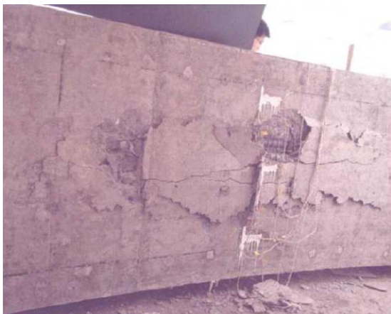
图1 预应力张拉时孔道保护层发生破坏
