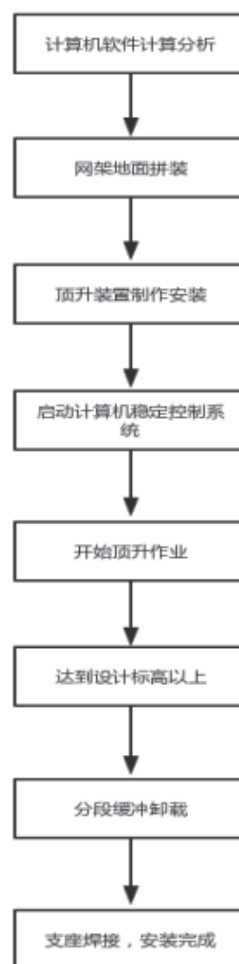
图2 施工工艺流程
