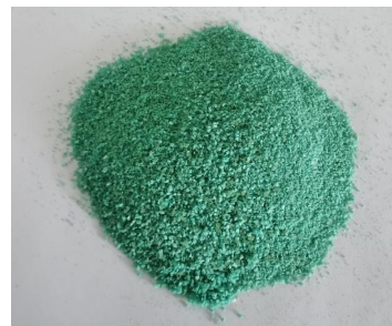
图2 NRP无车辙沥青路面改性剂
