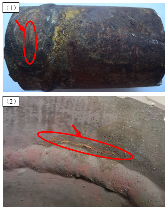
图1 裂纹周围的宏观形貌：（1）外壁侧（2）内壁侧
