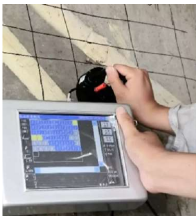
图1 使用钢筋监测仪实现无损探伤
