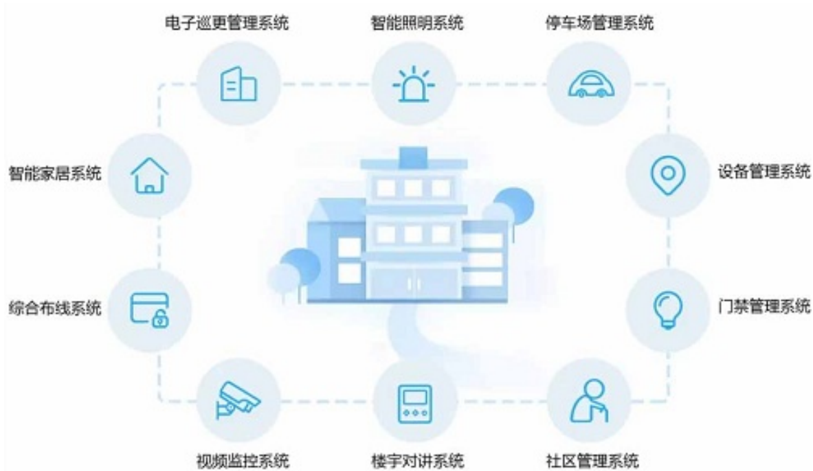
图1 建筑智能化系统工程施工的子系统
