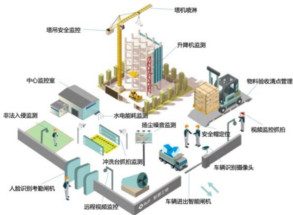
图2 建筑智能化系统工程施工的现场管理状态
