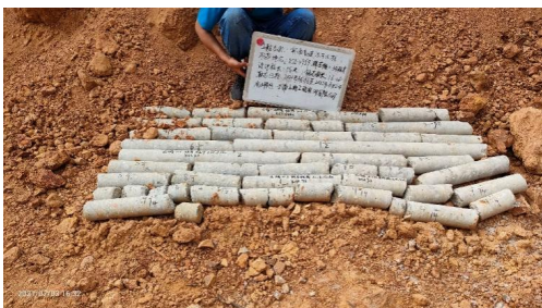
图8 某大桥11-3#桩底揭露全~强风化玄武岩
