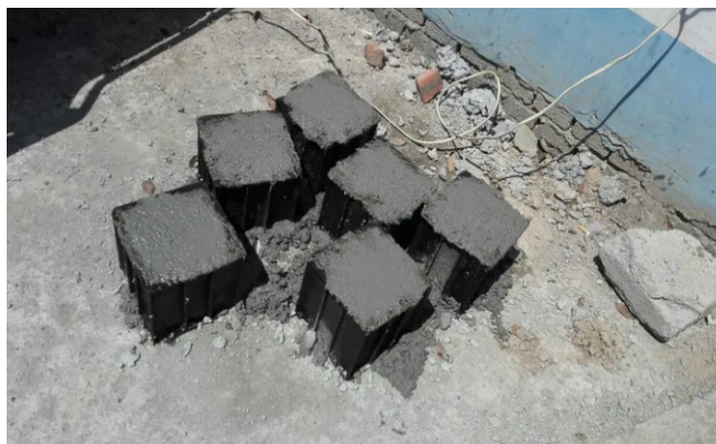
图1 混凝土试块采样
