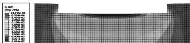
持力层在工况 1 下的地基反力图
