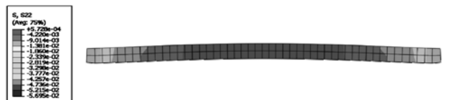
换填层在工况 2 下的地基反力图
