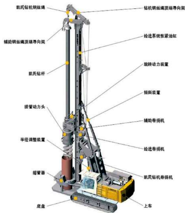
图2 挖钻机各部件示意图
