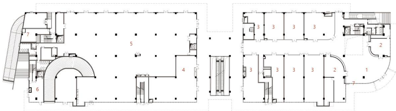
1门厅 2轻餐饮 3商铺 4便民服务中心 5菜场 6社工委门厅 7消控、监控中心
