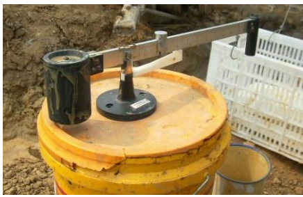
(上图)图1 泥浆比重实验1
