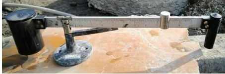
(上图)图2 泥浆比重实验2
