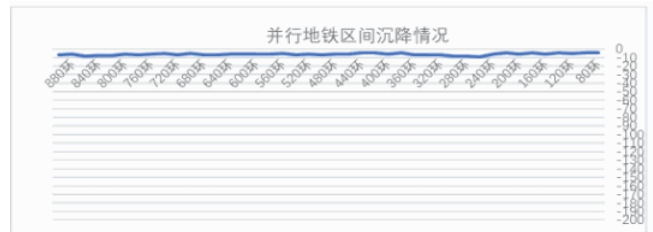
图4 江-星地铁隧道沉降监测表
