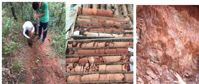
图1 坡顶串珠式土洞 图2 岩体破碎 图3 前缘剪出口处滑面光滑
