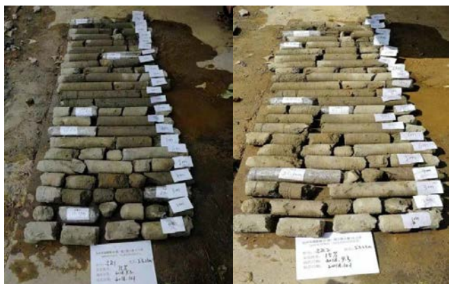
图4-1 试桩钻芯取样
