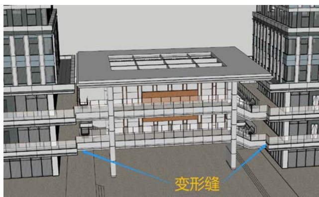
图3 变形缝位置示意图
