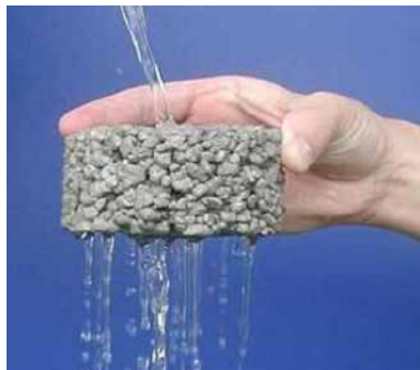
图1 透水混凝土对应透水性演示
