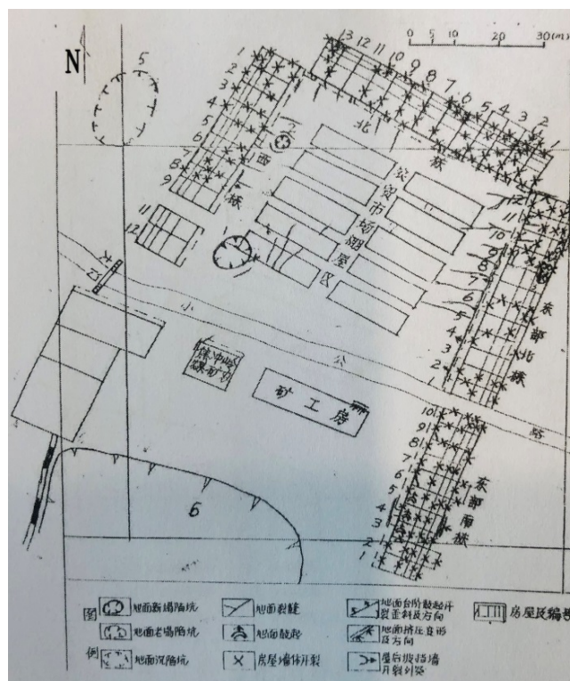
图1 农贸市场开裂塌陷分布图
