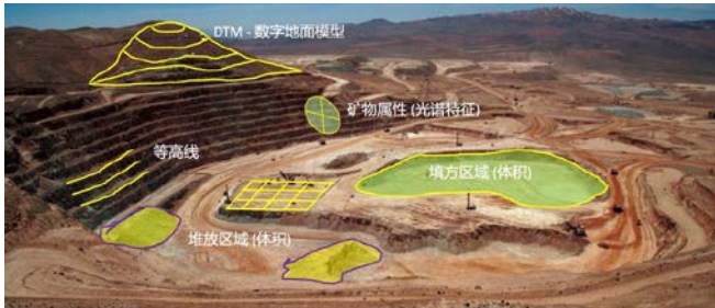
图3 无人机摄影测量技术在某矿山工程测量中的应用示意图
