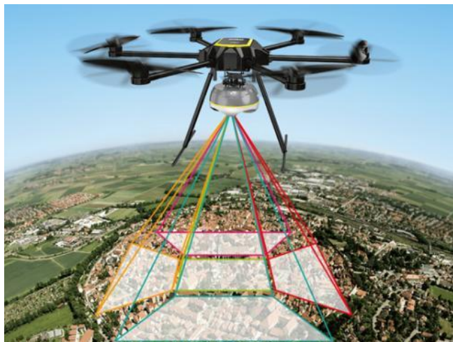
图1 无人机摄影测量技术在某地形测量工程中的应用示意图
