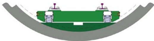
图1 隧道预制钢弹簧浮置板典型断面
