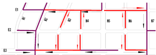
图5 优化调整后污水管线及流向示意图
