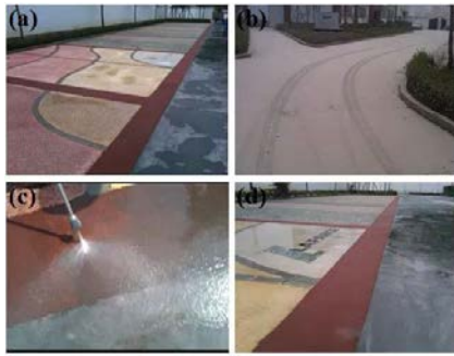
图3 项目情况测试：(a)一周后；(b)三个月后；(c)一年后清洗；(d)一年后
