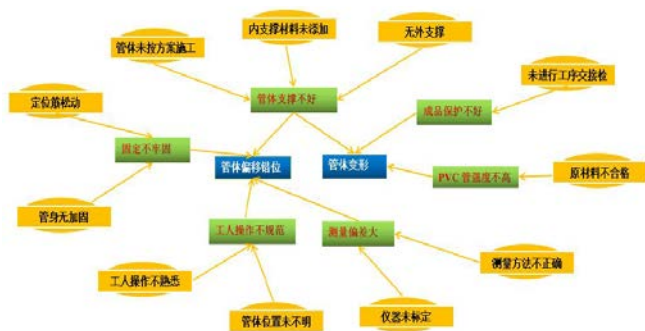
图1 影响排水孔外观质量的原因分析关联图
