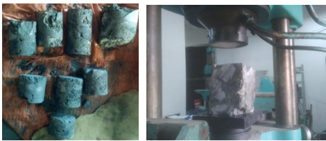
图3 固结体取芯试块和切割制作试块图
