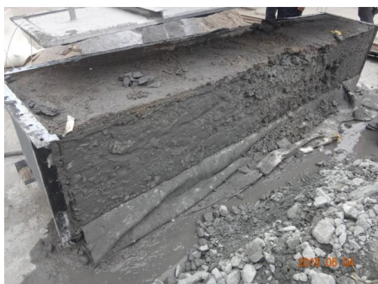
图2 注浆后箱体拆开实景图
