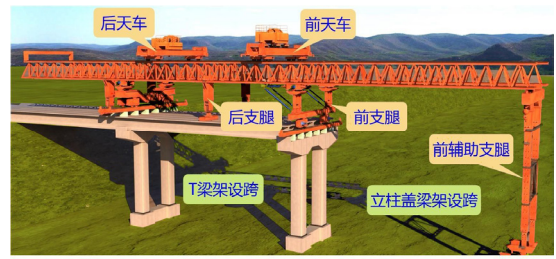
图2 一体化架桥机吊装施工图
