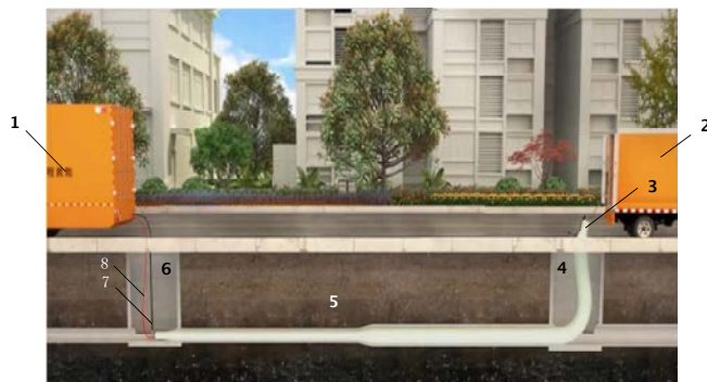
热塑成型法管道修复原理图
