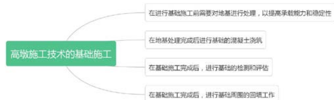
图1 高墩施工技术的基础施工
