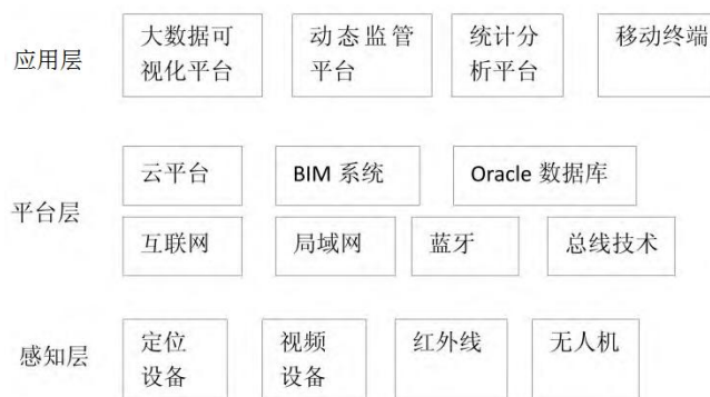
图1 以安全管理为目标的智慧工地管理系统架构图
