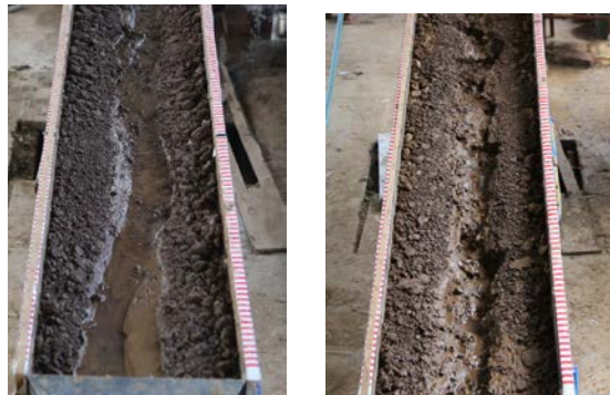
图3 低坡度跌坑数量较少情况 图4 高坡度跌坑数量及深度增加
