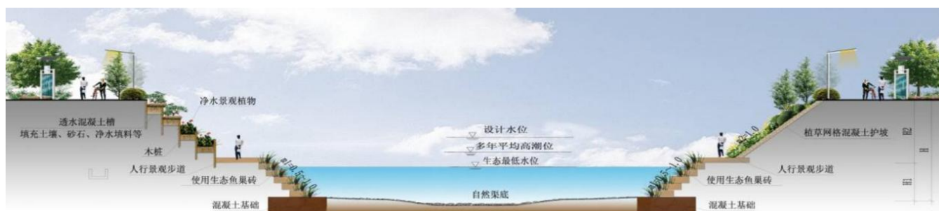
图1 生态堤防断面示意图
