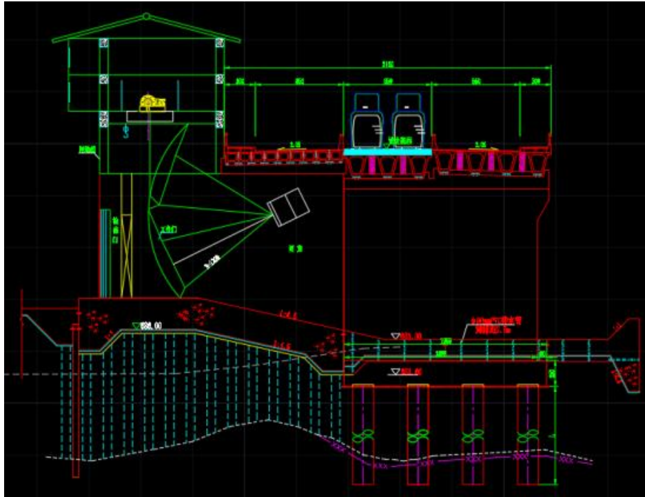
图1 拦河闸钻孔灌注桩典型断面图
