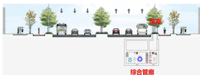
图2.1 综合管廊及风亭在道路横断面位置布置示意图
