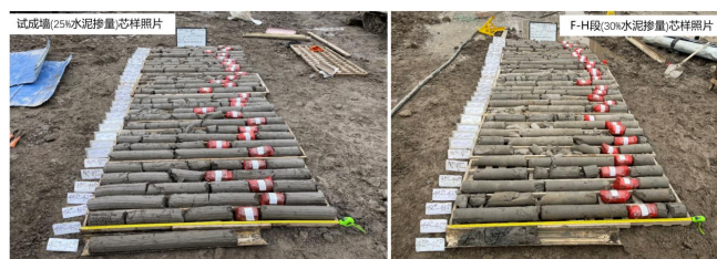
图3.2 试成墙(25%水泥掺量)、F-H段(30%水泥掺量)芯样照片
