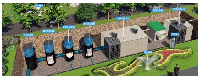
工民建施工中的雨水收集系统
